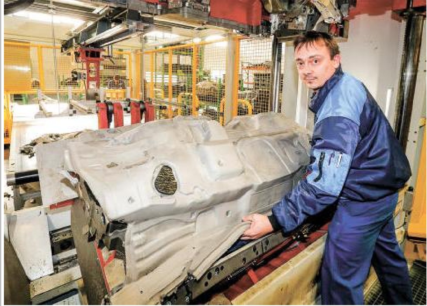
In der Produktion: Der Maschinenführer Alexander Jovic legt eine Stirnwandisolation (siehe auch Grafik unten) in eine Stanze ein. Diese schneidet überstehende Ränder ab. FOTOS (2): WOLFGANG RUDOLF
